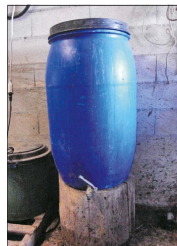
Tank à yogourt fait avec un tonneau de récupération auquel on a ajouté un robinet en bas. Attention, toujours bien brasser avant de soutirer!
