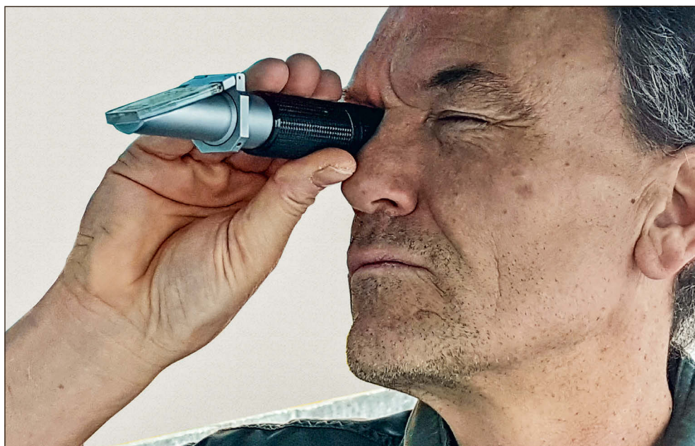
Le réfractomètre permet de contrôler la qualité immunologique du lait (taux d'anticorps).
